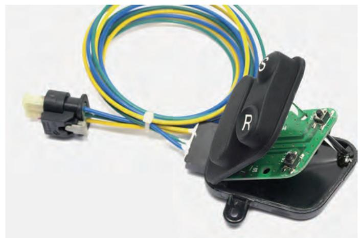
**Bild 13:** Wasserdichte Baugruppen, realisiert mit einer Silikonschaltmatte.
