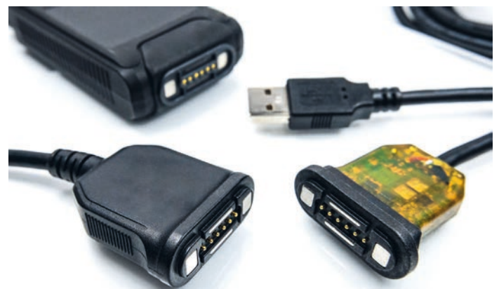
Verbindungskabel im Hotmelt Verfahren zum Schutz elektronischer Komponenten
