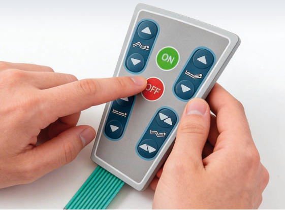
Bild 2: Tastengröße und -abstand verbessern die ergonomische Bedienpräzision
