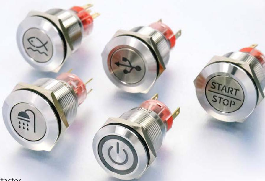
Wir bieten vandalismusgeschützte Edelstahl-Drucktaster mit individuellen, hinterleuchteten Symbolen. Mit einer Schutzklasse von IP67, Schlagfestigkeitsklasse IK09 und einem Temperaturbereich von -40°C bis +80°C eignen sich diese robusten Drucktaster für viele Anwendungsbereiche.
