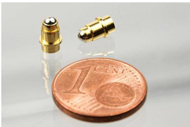
Das spezielle Design der Rolling Pin Federkontakte ermöglicht die zuverlässige Kontaktierung zwischen zwei Bauteilen bei seitlichen und rotierenden Bewegungen. Im Gegensatz zu einem herkömmlichen Federkontakt, wird beim Rolling Pin der Kolben um eine integrierte Kugel in der Pin-Spitze ergänzt. Im Miniaturbereich von unter 10mm Gesamtlänge waren bisher Ströme von bis zu 2A möglich, wobei 1A der Standard sind.
