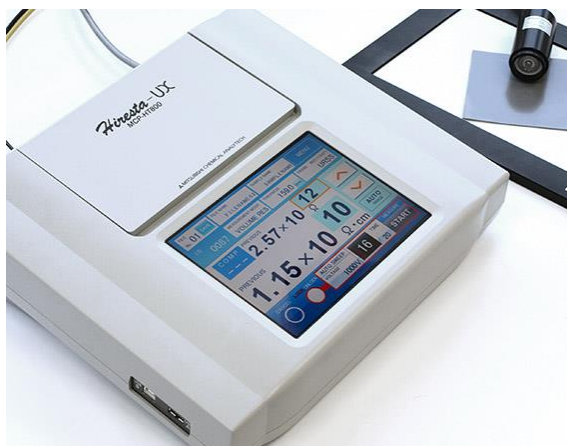
Leitfähigkeitsmessgerät Hiresta-UX für den hochohmigen Bereich mit Ringelektroden-Messkopf
