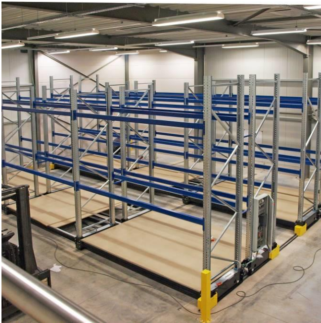
Einbau des neuen Verschieberegalsystems
